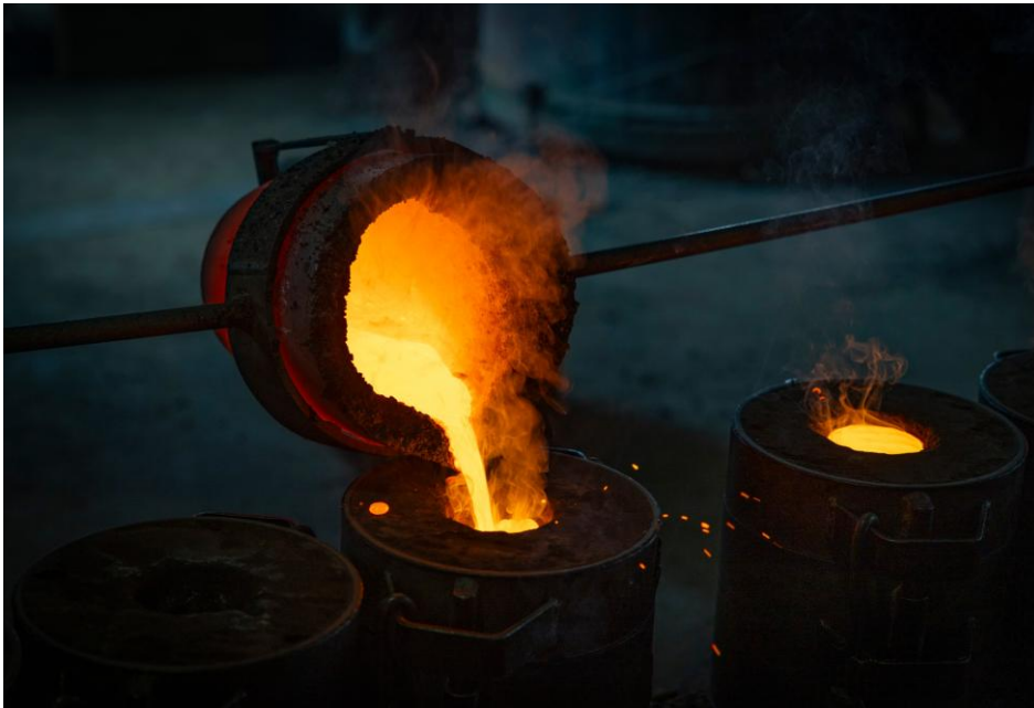
Die Bronze ist fast 1300 Grad Celsius heiss, wenn sie in die Form gegossen wird. Foto: Beat Mathys
